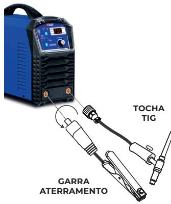
**1** - Conecte o porta eletrodo ao pólo positivo da máquina e tenha certeza de que ao girar o mesmo esteja bem fixado. Evite mau contato.
