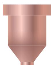
O bico de corte possui um **pequeno orifício** calibrado por onde passa o plasma. Se o orifício ficar parcialmente bloqueado, deformado ou aumentado, o bico de corte deve ser substituído.
