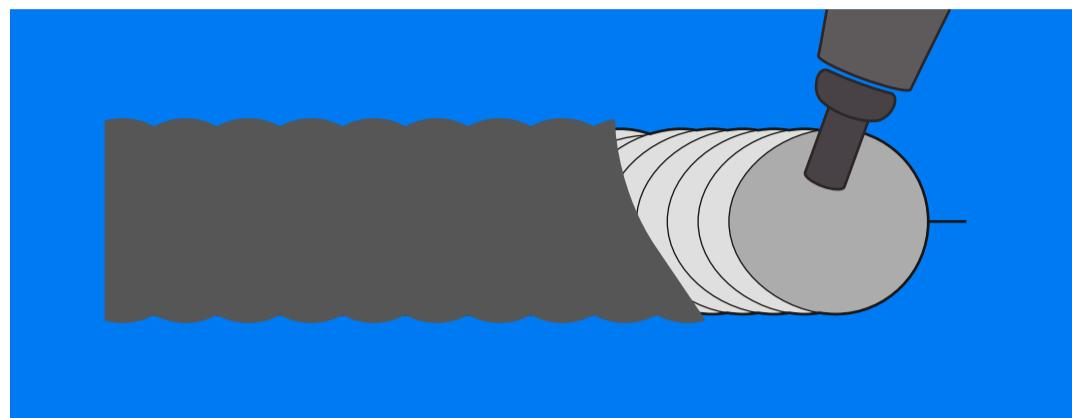
A **escória** protege a solda contra as impurezas. Após a solda finalizada, é aconselhado que se retire a escória com uma picadeira de solda.
